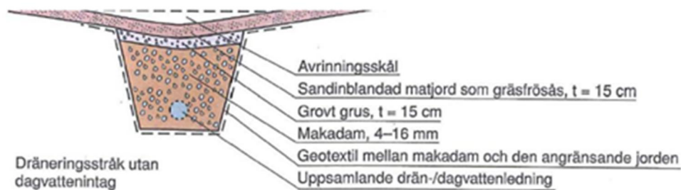
Figur 16. Principbild på makadamdike.
